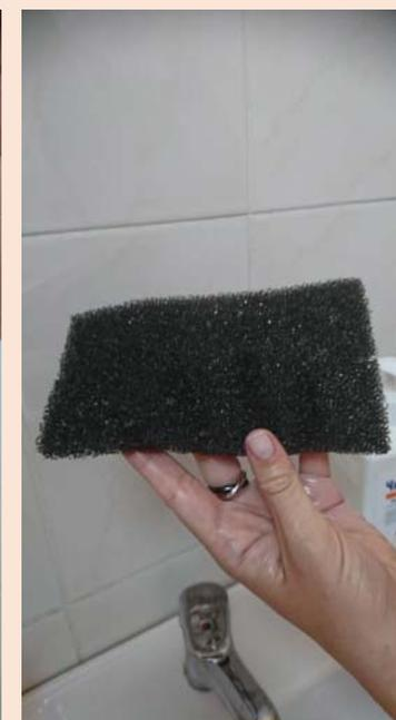
6. Для просушки выложите фильтр на любую горизонтальную поверхность вдали от источников тепла (батарея, полотенцесушитель, обогреватель и т.п.)
